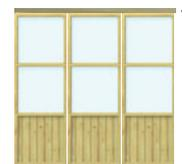
Mehrfachkonstruktionen gegen Winddruck mit Aufsatzleiste (Q) oben und unten stabilisieren.
